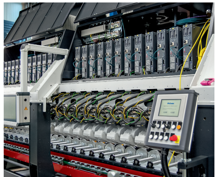
Die geöffnete Anlage zeigt die Vielzahl der Steuerungs-PCs der Roboter; Bediener programmieren mit einem intuitiven Bedienfeld (HMI). Kleine Änderungen sind auch im Prozess noch möglich
