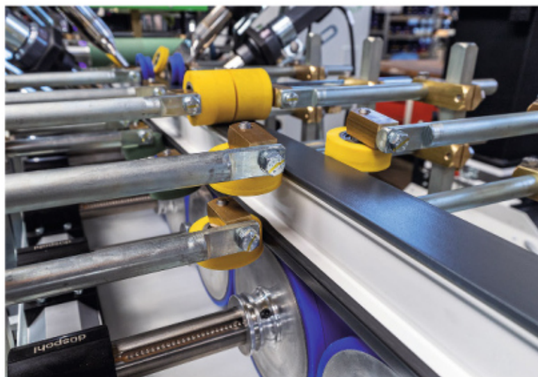
Doppelseitig kaschiertes Profil in der Ummantelungszone.
