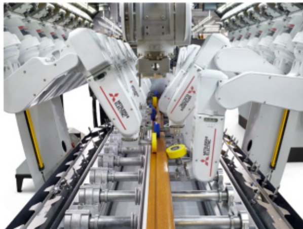
Die Anlage RoboWrap fertigt auf Basis künstlicher Intelligenz vollautomatisch und mit minimaler Rüstzeit neue Profile.
