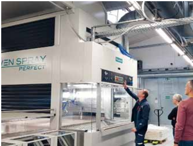
Mit der Lackieranlage „Ven Spray Perfect“ lassen sich hohe Kanten optimal beschichten
