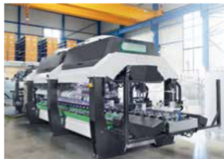
RoboWrap verfügt über ein neues automatisches Rollenwechselsystem.
