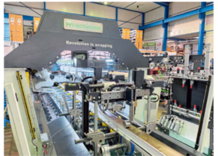
„RoboWrap“ heißt die Hightech-Maschine, die voll automatisiert die unterschiedlichen Profile ummantelt. Gemeinsam mit Forschern des Fraunhofer IEM entwickelten die Düspohl-Techniker die Software inklusive Robotersteuerung in dieser weltweit ersten voll automatisierten Anlage.
